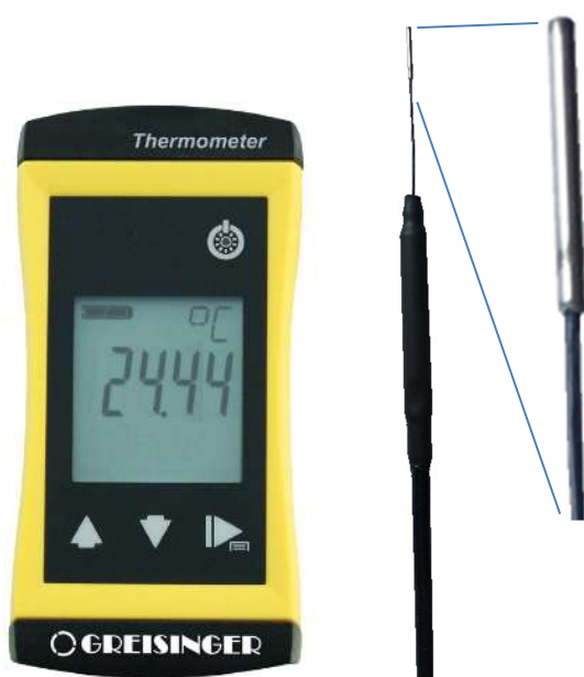
G 1781 s pevně připojeným miniaturním snímačem
